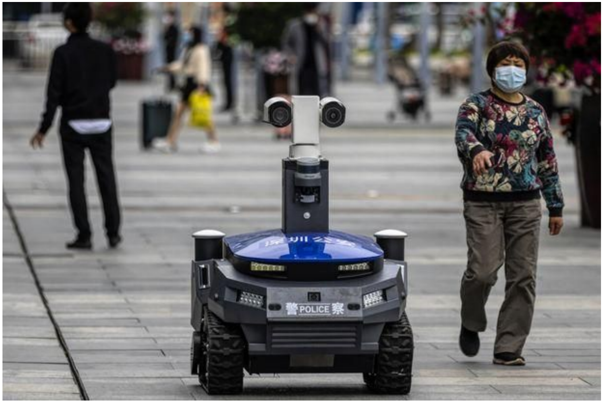
자율주행하면서 체온을 측정하는 동시에 마스크를 착용하지 않는 사람을 기록할 수 있는 경찰 로봇. (사진=평파이신원)
