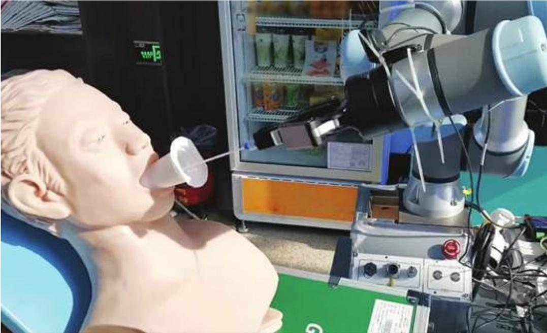
중국 칭화대학이 개발한 체온 측정, 청진, 초음파, 목구멍 검체채취 가능 '코로나19 바이러스, 격리 병실 순찰 로봇' (사진=난충르바오)
